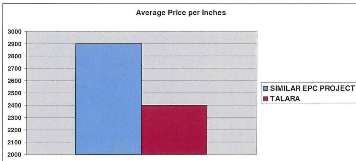
Los gráficos muestran que el Proyecto de Talara está caracterizado por un tamaño medio de Válvula de Control de 3 pulgadas y un precio medio por pulgada de 2.400 USD. El proyecto similar de referencia tiene un tamaño medio de 3.3 pulgadas y un precio medio por pulgada de 2.900 USD.
